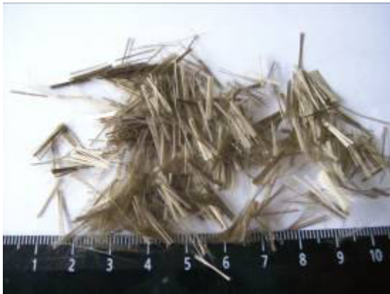
Рисунок 1 – Базальтова фібра довжиною 15 – 30 мм і діаметром волокон 13 – 18 мкм
