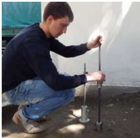
Рисунок 6 – Порівняння роботи ударників при визначенні щільності ґрунту
