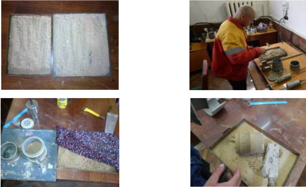
Рисунок 7 – Процес визначення щільності за методом Проктора
