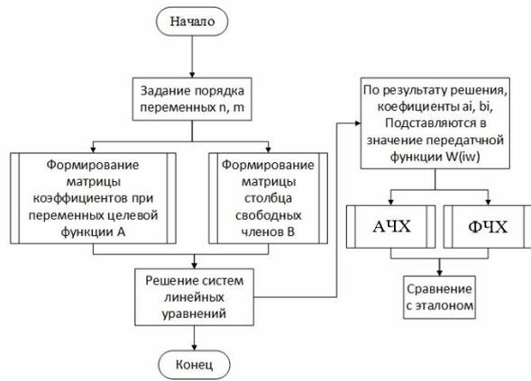
Рис. 2. Схема алгоритма моделирования расчета параметров ЦФ БИХ и оценки их характеристик
